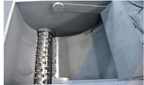
Estos molinos utilizan cuchillas cóncavas de base cuadrada que proporcionan un resultado de alta calidad. Los cuchillos de estas máquinas se pueden voltear cuando se desgasta uno de sus lados.
