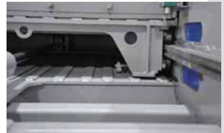
El sistema ZCS utiliza un empujador de sólida fabricación con guía de rodillos tipo gaveta para alimentar el material al triturador. La cámara de corte y el empujador segmentados permiten que se procese material delgado sin ningún problema.
