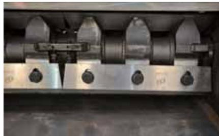
El molino en los ZCS utiliza un rotor F+ para asegurar una efectiva entrada y flujo del material, al mismo tiempo que logra procesar hojuelas gruesas y pesadas.
